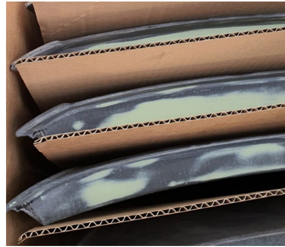
Richtiges Spachteln und Schleifen ist Voraussetzung für eine gute Lackierung:
