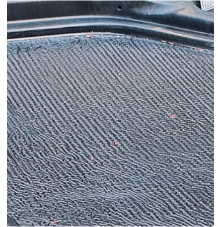
Für den Leichtbau sind Bauteile aus Kohlefaser sehr interessant, hier im Bild eine Motorhaube.
