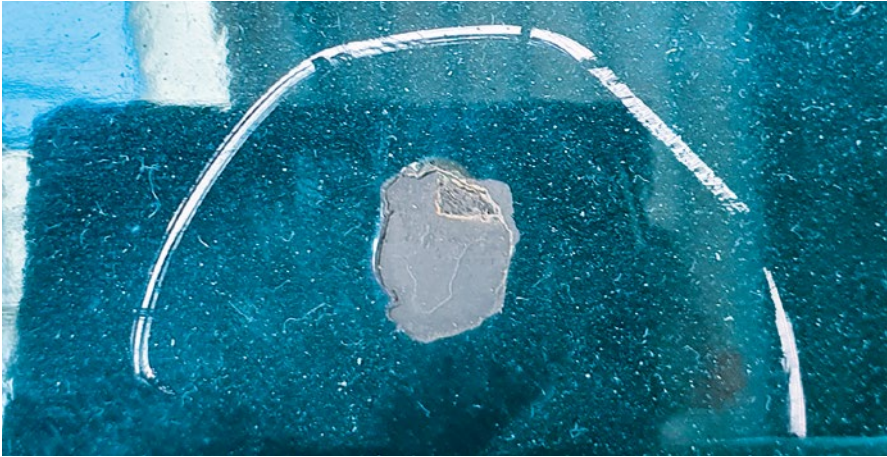
im vorliegenden Anwendungsfall hatten unter anderem Fehler beim Spachteln und Schleifen zu Lackabplatzungen und zusätzlicher teurer Nacharbeit geführt.
