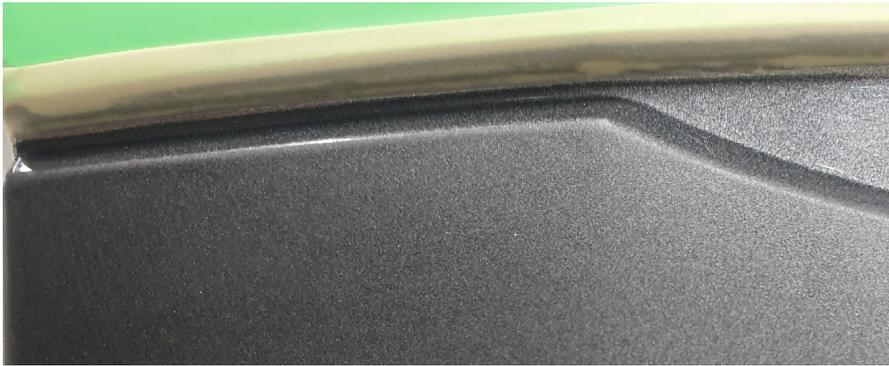
Vor der Lackierung müssen Details eines hinteren Autostoßfängers mit Feinlinierklebung per Hand und Schablonenkontrolle für die Zweifarblackierung kaschiert werden.
